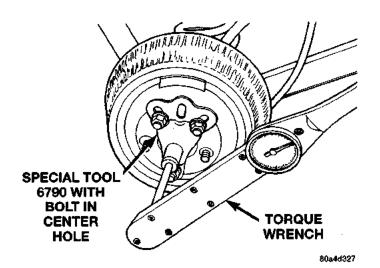
Fig. 5 Trac-lok Test
