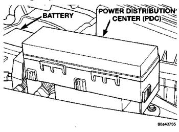
Fig. 33 Power Distribution Center (PDC)
