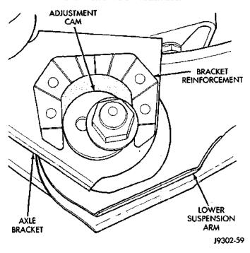
Fig. 1 Cam Adjuster
