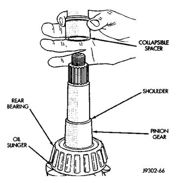
Fig. 36 Collapsible Spacer
