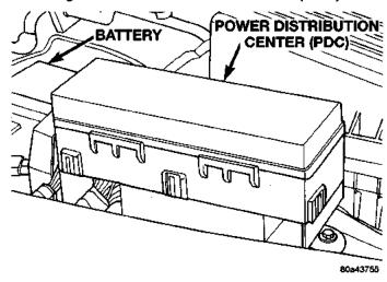
Fig. 15 Power Distribution Center (PDC)
