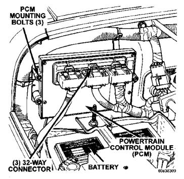
Fig. 11 Powertrain Control Module (PCM)
