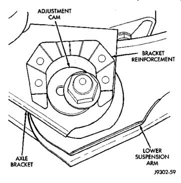
Fig. 2 Cam Adjuster
