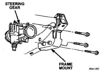
Fig. 4 Steering Gear
