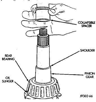
Fig. 31 Collapsible Spacer
