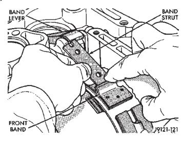
Fig. 74 Front Band Strut
