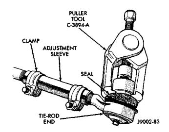
Fig. 2 Ball Stud Removal
