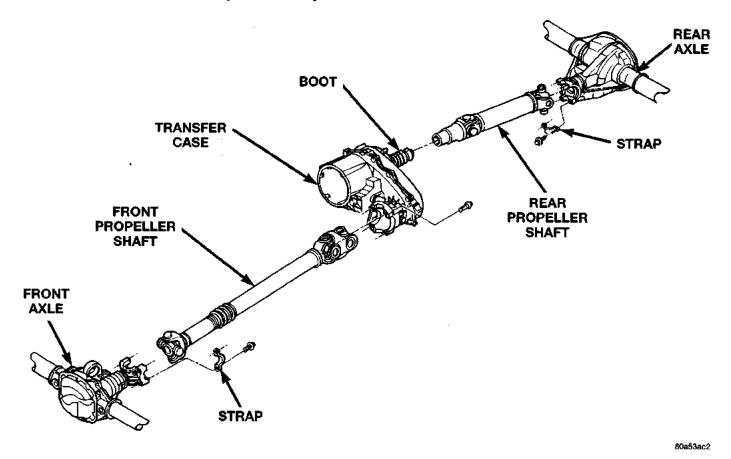
Fig. 1 Propeller Shafts
