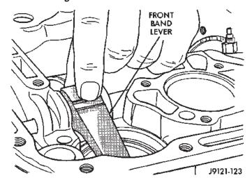
Fig. 89 Front Band Lever
