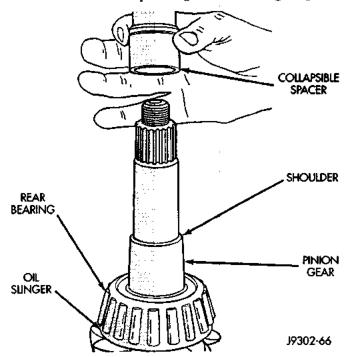
Fig. 37 Collapsible Preload Spacer
