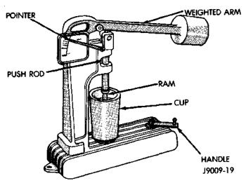
Fig. 1 Leak-Down Tester
