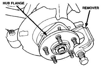
Fig. 9 Wheel Stud Removal
