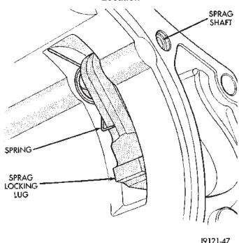
Fig. 169 Correct Position Of Sprag And Spring
