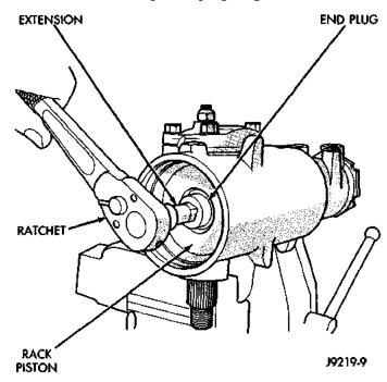
Fig. 19 Rack Piston End Plug
