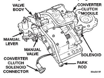
Fig. 29 Valve Body
