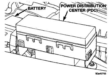
Fig. 2 Power Distribution Center (PDC)
