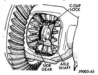
Fig. 15 Axle Shaft C-Clip Lock
