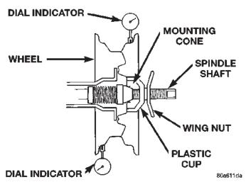
Fig. 3 Radial Runout
