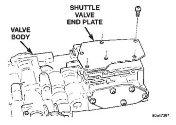
Fig. 55 Shuttle Valve End Plate
