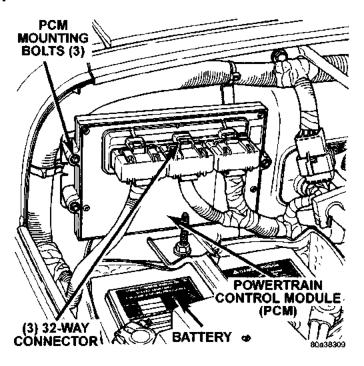
Fig. 14 Powertrain Control Module (PCM)
