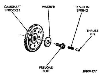
Fig. 33 Camshaft Sprocket Preload Bolt
