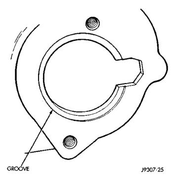
Fig. 29 Thermostat Recess
