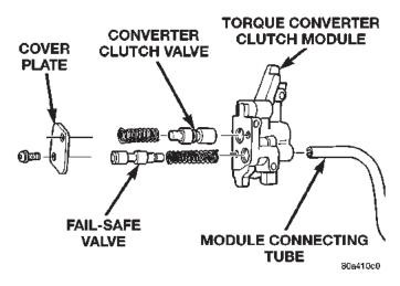
Fig. 60 Converter Clutch Valve Module
