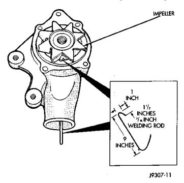
Fig. 13 Impeller Test-Typical
