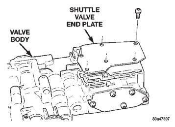
Fig. 51 Shuttle Valve End Plate
