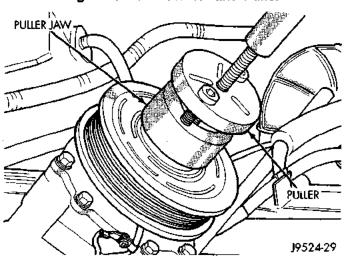
Fig. 16 Install Puller Plate
