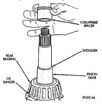
Fig. 43 Collapsible Preload Spacer
