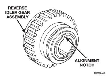
Fig. 91 Align Idler Shaft Pin
