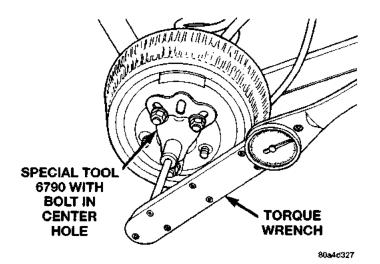
Fig. 5 Trac-lok Test
