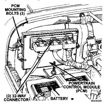
Fig. 1 Powertrain Control Module (PCM) Location
