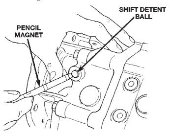
Fig. 44 Install Detent Ball
