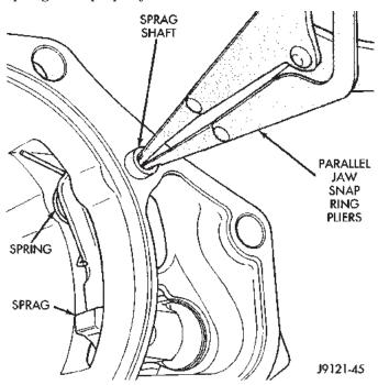
Fig. 167 Park Sprag, Shaft And Spring
