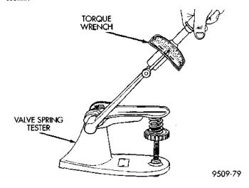
Fig. 62 Valve Spring Tester
